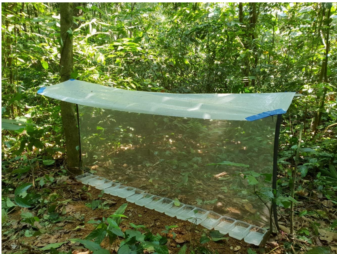
Рисунок 1 – «Прерывающая полет» ловушка, установленная в Национальном парке Кук Фонг во время проведения исследований в 2019 г.
